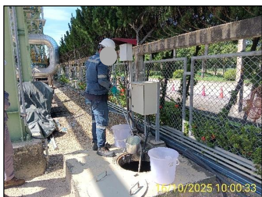
ภาพถ่ายที่ 3.4.6-1 การเก็บตัวอย่างคุณภาพน้ำทิ้งจากบ่อตรวจวัดคุณภาพน้ำเสียของโครงการ (Inspection Manhole)
